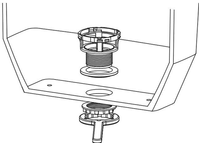
! COMPATIBLE : la soupape peut se clipser directement sur un culot prémonté de marque FIXOCONNECT, SOMATHERM FOR YOU ou SIAMP.
