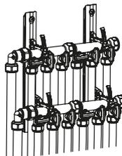
7 - Positionnez les vignettes adhésives sur les clips de fixation, puis fixez ces derniers sur les tubes afin de repérer les pièces du réseau.
