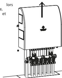
11 - Dans le cas d'une prolongation ou d'une arrivée par le côté, les fenêtres latérales du cache sont découpables.
