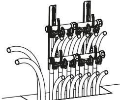
5 - Pour verrouiller les languettes, pincez légèrement l'attache entre le pouce et l'index puis rabattez les languettes vers le bas, sur les collecteurs.
