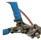
Poser le raccord dans la rainure de la mâchoire et presser.
