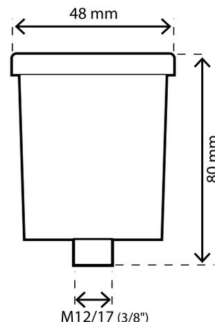
Le purgeur d'air automatique permet d'éliminer l'air dissout dans l'eau de chauffage qui, avec les variations de température et de pression, redevient gazeux. Le purgeur d'air automatique s'installe sur tous les points hauts de l'installation (quand la tuyauterie redescend).
