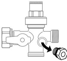
2 Mettre du ruban PTFE ou un joint torique sur la partie fileté du manomètre.
