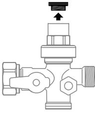
2 Régler la pression de sortie à l'aide d'un tournevis plat.
