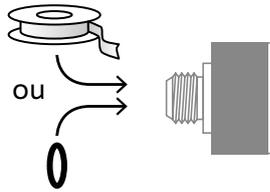
3 Visser le manomètre (sans forcer) jusqu'en butée pour assurer l'étanchéité.
