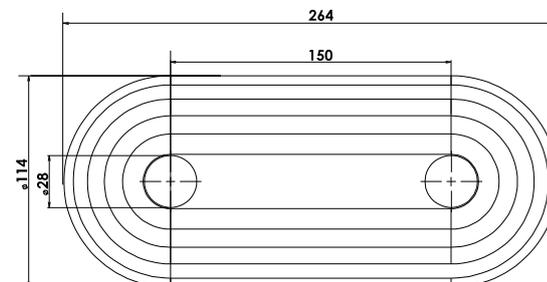
**KITFIXOCAR** - permet de rallonger un raccord FIXOPLAC supportant ainsi l'épaisseur d'une surface carrelée (livré avec un adaptateur M/F, des joints et une rosace de finition).
