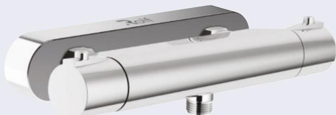
**Innovation**, La réglette d'entraxe permet de poser une robinetterie entraxe universel 15cm lorsqu'en rénovation les arrivées d'eau sont sur des entraxes spécifiques compris entre 5.5 et 13cm
