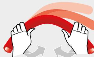
Il existe 2 types de PER obtenus par des méthodes de réticulation différentes. La plupart des installations peuvent se faire en PEX-B mais en cas d'installations difficiles, le PEX-A, dont la réticulation atteint 70%, est plus adapté car plus souple et plus résistant.
