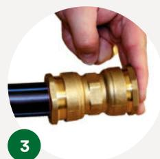
**3** Insérer le tube dans le raccord jusqu'à la butée (repère d'emboîtement), après avoir desserré l'écrou de quelques filets.
